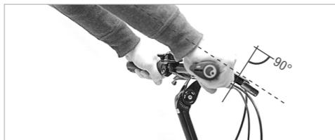
Um die Bremshebel auch bei kleineren Händen sicher greifen zu können, wird der Bremshebel mit einer Stellschraube (im Hebel) weiter an den Lenker herangestellt.
