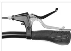
Stellen Sie die Zugspannung so ein, dass der Bremshebel auch bei starker Betätigung nicht den Lenkergriff berührt!
