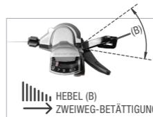
UMSCHALTEN VON EINEM GRÖßEREN AUF EINEN KLEINEREN ZAHNKRANZ (HEBEL B)
