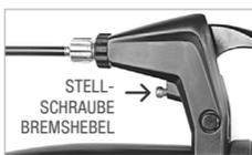
Bei einigen Modellen ist es möglich, die Bremshebel mit speziellen Vorrichtungen näher an den Lenker zu stellen.
