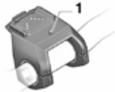
Abb.: Halterung des Bediencomputers 1 Blockierungsschraube
