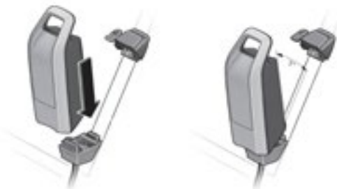
Abb.: Rahmenakku einsetzen
